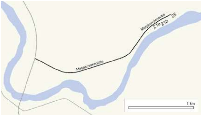
Kuva 17. Etäisyyteen perustuva 100-jakoinen osoitenumerointijärjestelmä. Marjasuvannontie, Savukoski. 100 metrin jaotus sopii käytettäväksi vain hyvin harvaan asutussa kunnassa. Pohjakartta: Maanmittauslaitos.
